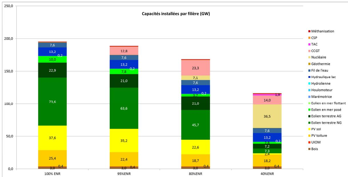
Figure 106 - Comparaison des mix optimaux 100%, 95%, 80% et 40% ENR
