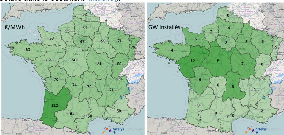
Figure 59 - Comparaison entre les répartitions par région des capacités installées (à droite) et des LCOE (à gauche) de la filière éolienne NG
