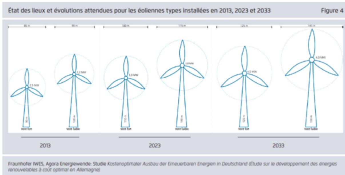
Figure 24 - Evolution des caractéristiques des éoliennes – source Fraunhofer
