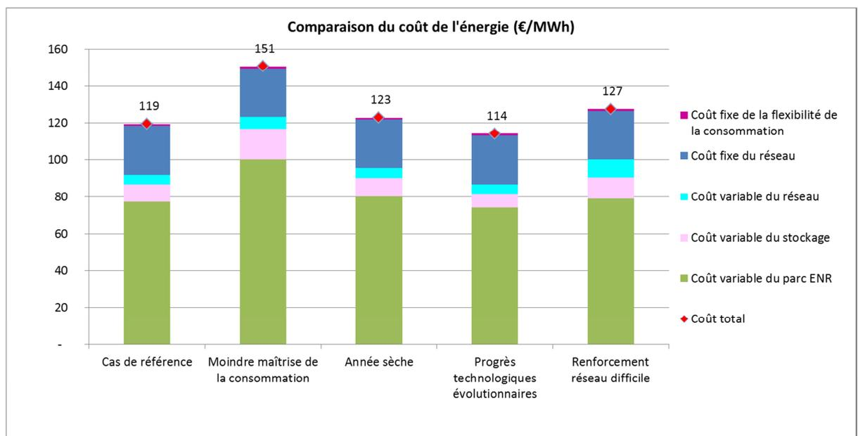
Figure 77- Coût de l'électricité (€/MWh) du cas de référence et des variantes
