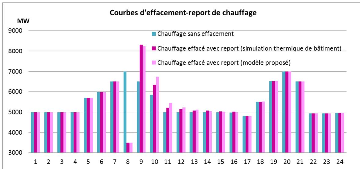
Figure 16 - Modèle de report des effacements de chauffage
