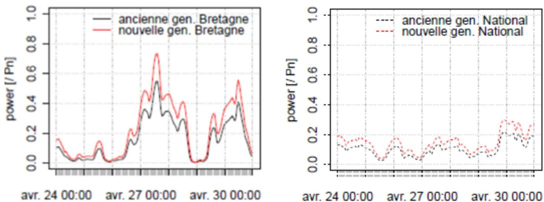
Figure 25 - Episode de production lors d'une semaine avec peu de vent pour la Bretagne (à gauche) et la France entière (à droite). La production est ramenée à la puissance installée. La valeur 1, atteignable pour une turbine donnée, n'est pas atteinte au niveau de la région Bretagne, et encore moins au niveau national, en raison du foisonnement.
