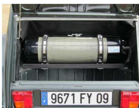
Bouteille Composite équipant la 2CV
