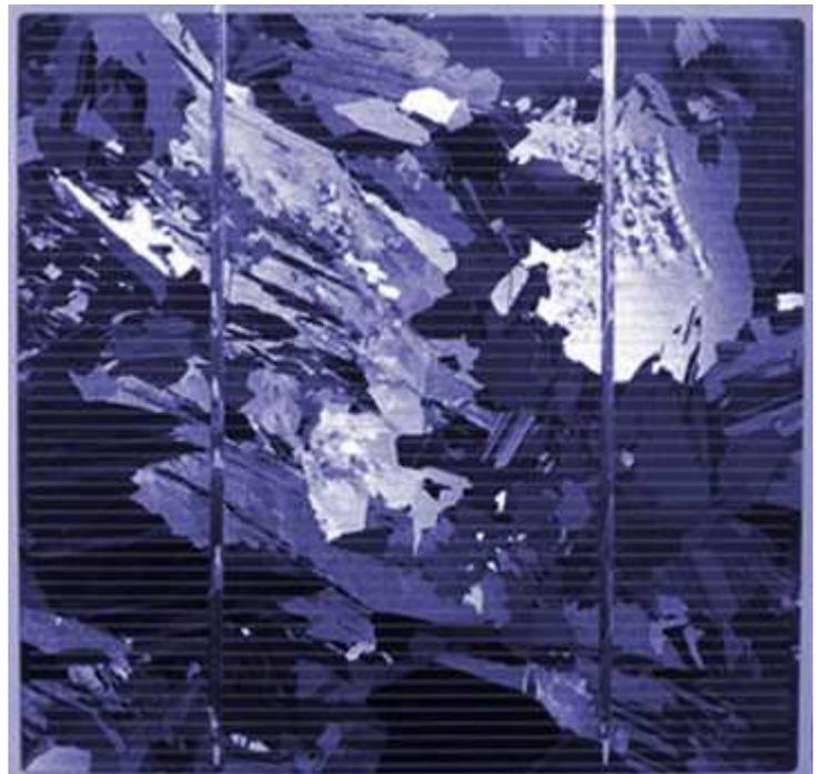
Vorteile : die diffuse Strahlung wird besser in Elektrizität konvertiert, ausreichende Ausgabe, Lebensdauer über 30 Jahre, quadratischer Zelle, die auf dem Bauelement einen perfekten Straßenpflaster erlaubt, 12 bis 16% Wirkungsgrad und ungefähr 140 Wc/m<sup>2</sup>, viel weniger teure Module als der monoKristall, der die beste Rate kraft / Preis gibt.
