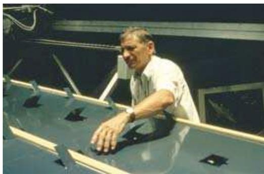
Modèle de toit à double paroi permettant aux courants d'air naturels de rafraîchir la température d'une habitation testé dans un simulateur solaire au CEA/Cadarache.
